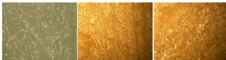
а – сталь ХВГ i = 1 \text{ А/см}^2 , \tau = 10 \text{ мин} б – сталь ШХ15 i = 1 \text{ А/см}^2 , \tau = 10 \text{ мин} в – сталь У8 i = 1 \text{ А/см}^2 , \tau = 10 \text{ мин} Рис. Примеры фактур, полученных на поверхностях различных сталей
